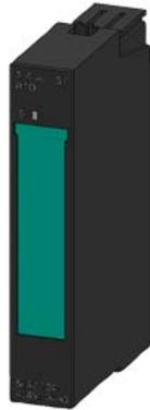
SIMATIC DP, módulo electrónico para ET 200S, 2/4 AI RTD estándar, 15 mm de ancho, 15 bits + signo Pt100 STD; Pt100 KL; NI100 STD; NI100 KL; 150 ohmios; 300 ohmios; 600 ohmios; tiempo de ciclo 110 ms/canal con LED SF (fallo agrupado)
