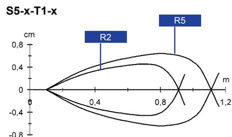
I diagrammi di rilevazione indicano la distanza operativa tipica con excess gain 1
